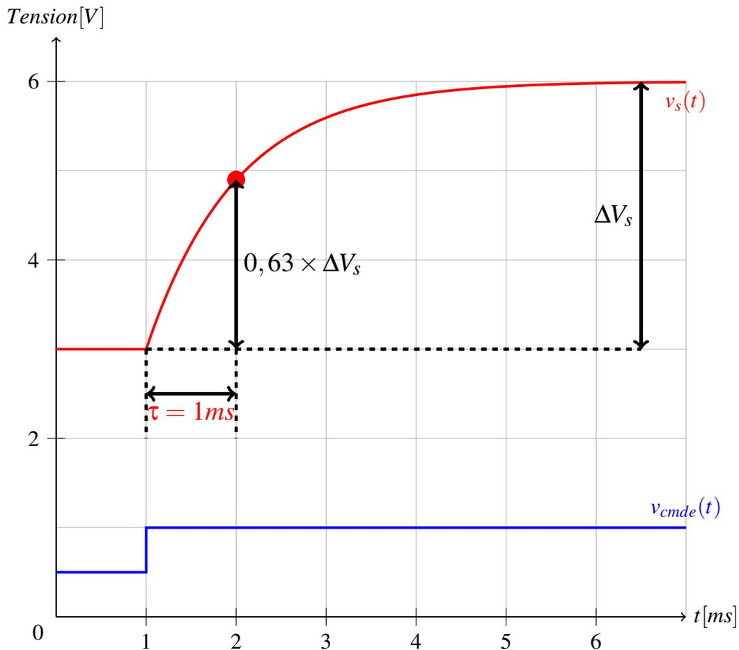
FIGURE 3 – Essai indiciel
