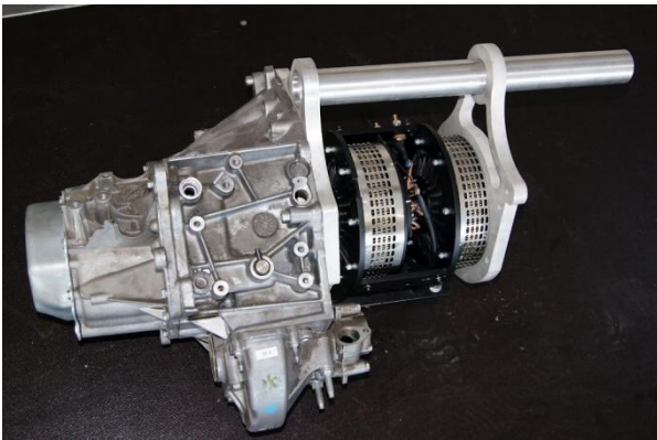
fig.3 : Accouplement des 2 moteurs utilisés
